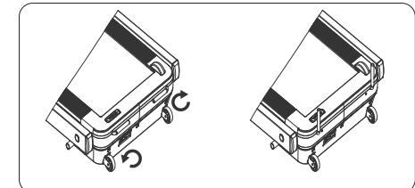
2. 确保跑步台锁好后，站在跑步机后面，抓住跑台尾端如图三，立起跑台如图四。
