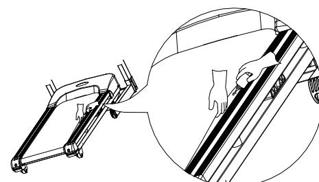
注意:加油时不要过猛,以免加油过量。加完油后将滴到侧板上和跑步带表面的油用抹布擦干净。
